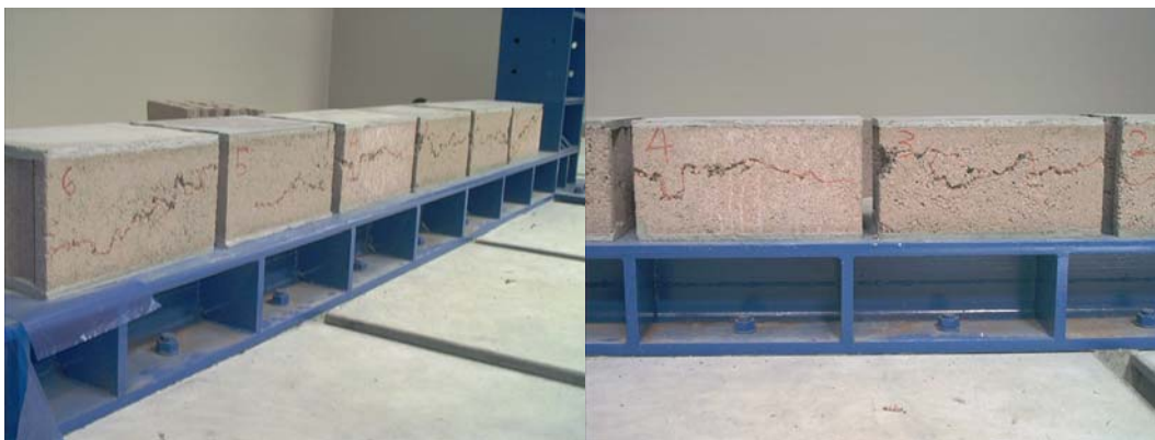
Fig.8: Aspecto geral da configuração de rotura dos provetes após ensaio à compressão
