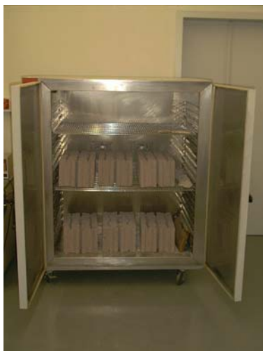
Fig.5: Colocação dos blocos em estufa
