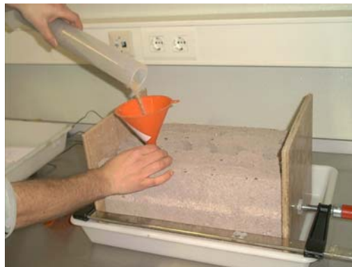
Fig.2: Realização do ensaio para a determinação do volume efectivo e percentagem de vazios
