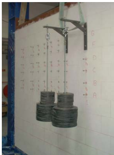
Fig.13: Dispositivo para aplicação de carga excêntrica
