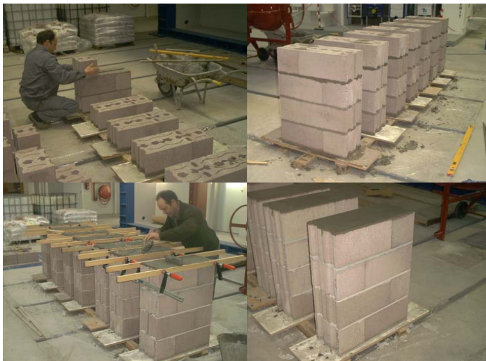
Fig.23: Representação de algumas das fases da execução dos provetes de alvenaria
