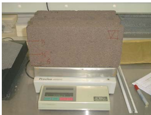
Fig.3: Pesagem e registo dos pesos dos blocos
