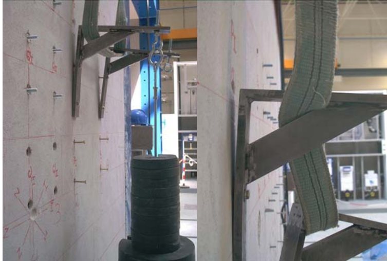
Fig.18: Momento da rotura do sistema pelas fixações com bucha plástica (Carga aplicada apenas em um esquadro)
