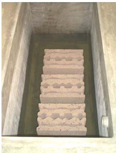
Fig.4: Colocação dos provetes em tanque com água
