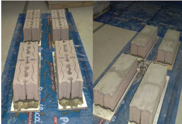
Fig.6: Preparação e regularização das superfícies dos provetes para ensaio à compressão
