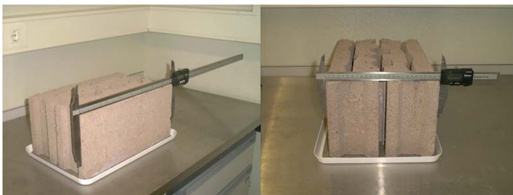
Fig.1: Exemplo representativo da determinação das dimensões.
