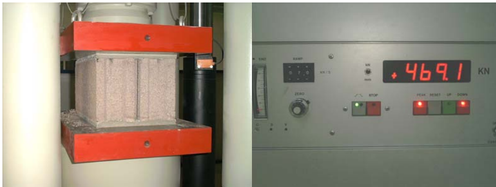
Fig.7: Posicionamento do provete na máquina de ensaio à compressão e medição da carga de rotura
