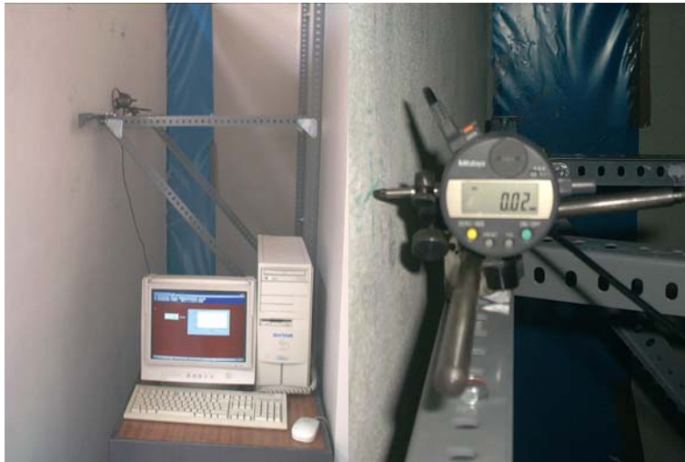
Fig.12: Sistema de medição das deformações da parede
